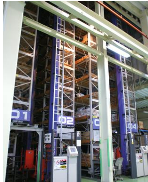
金型・原料自動倉庫
